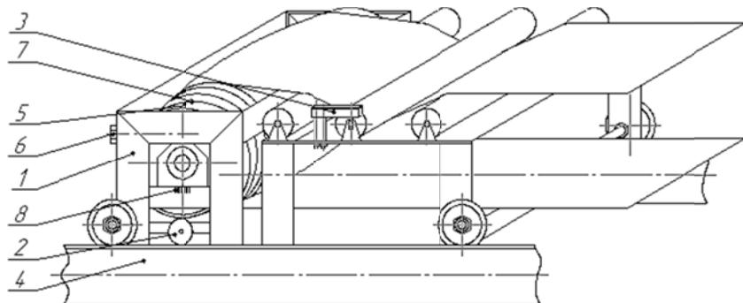
Рис. 2. Конструктивная схема измерительного узла величины и времени схода ленты:
