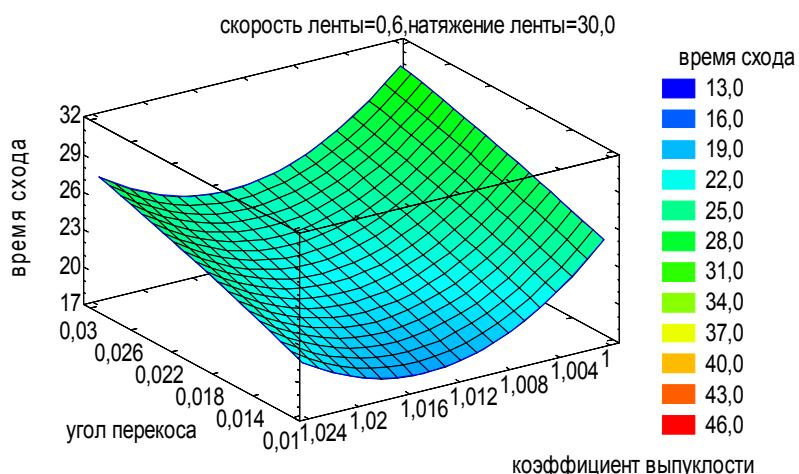
Рис. 5. Поверхность отклика величины  $t = f(\alpha, K_{вып.})$  при развороте барабана
