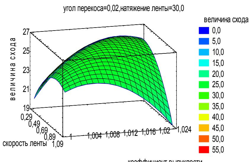
Рис. 4. Поверхность отклика величины  $y = f(V, K_{выхн.})$  при развороте барабана
