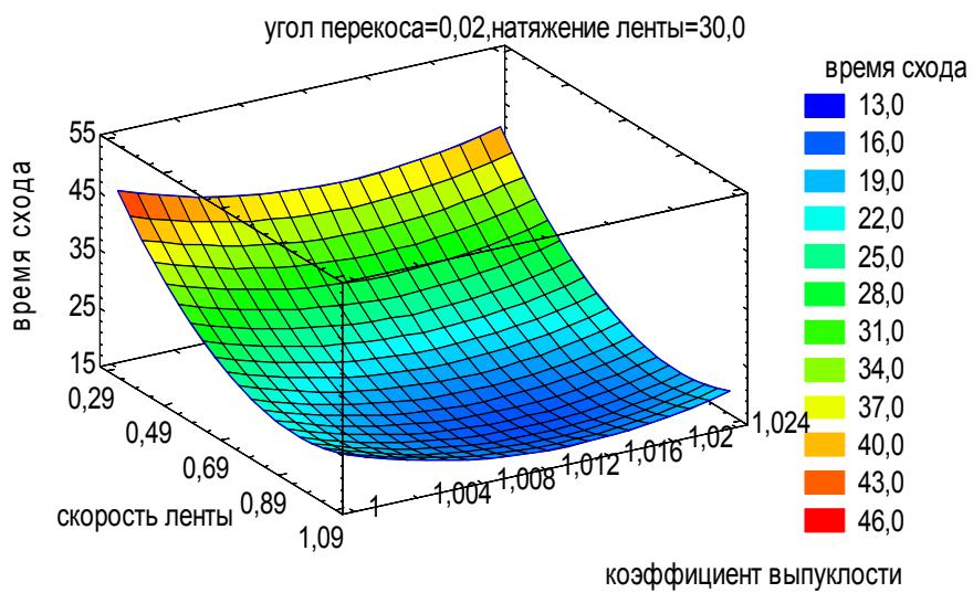
Рис. 6. Поверхность отклика величины  $t = f(V, K_{вып.})$  при развороте барабана
