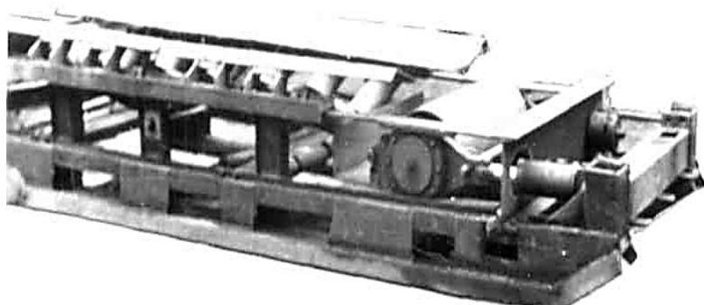
Рис. 7. Концевая станция ленточного конвейера 1ЛТ-80 с аппаратурой регулирования поворота барабана в горизонтальной плоскости
