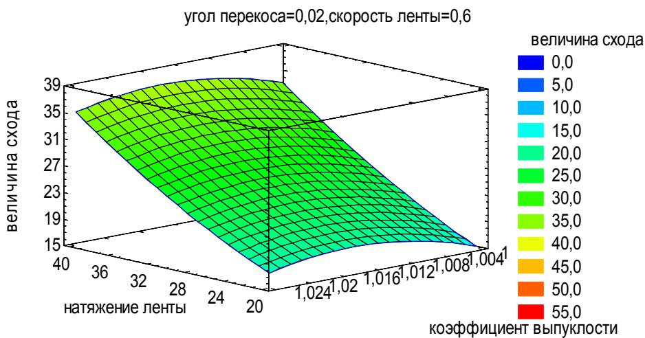
Рис. 3. Поверхность отклика величины  $y = f(G, K_{выхн.})$  при развороте барабана
